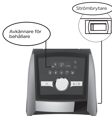
Kontrollpanelen på A3500i
