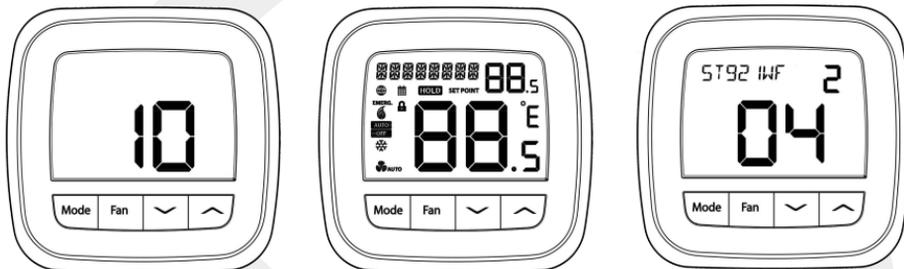
La première fois que le ST921WF est allumé, ou après réinitialisation d'usine, la séquence de démarrage ci-dessus s'affiche. Le dernier écran affiche les numéros de modèle du thermostat et de version du micrologiciel.
