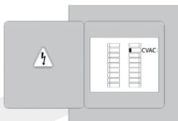
Retourner au commutateur de la fournaise ou au boîtier de disjoncteurs et remettre le système CVAC sous tension.
