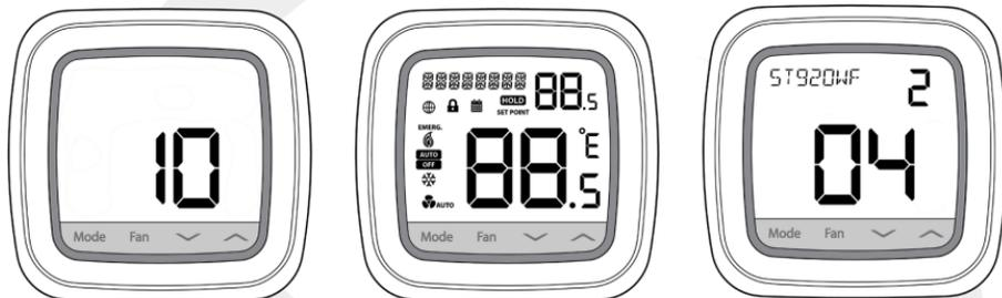
La première fois que le ST920WF est allumé, ou après réinitialisation d'usine, la séquence de démarrage ci-dessus s'affiche. Le dernier écran affiche les numéros de modèle du thermostat et de version du micrologiciel.
