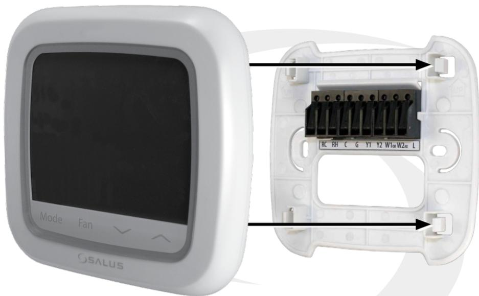
**Fixer l'écran sur la plaque de montage** : Aligner les logements au dos du thermostat avec les tiges de la plaque murale et appuyer pour bien fixer. Vérifier que les tiges de connexion ne sont pas pliées et qu'aucun fil ne nuit à l'insertion. Le thermostat doit être parfaitement appuyé sur la plaque murale pour bien fonctionner.
