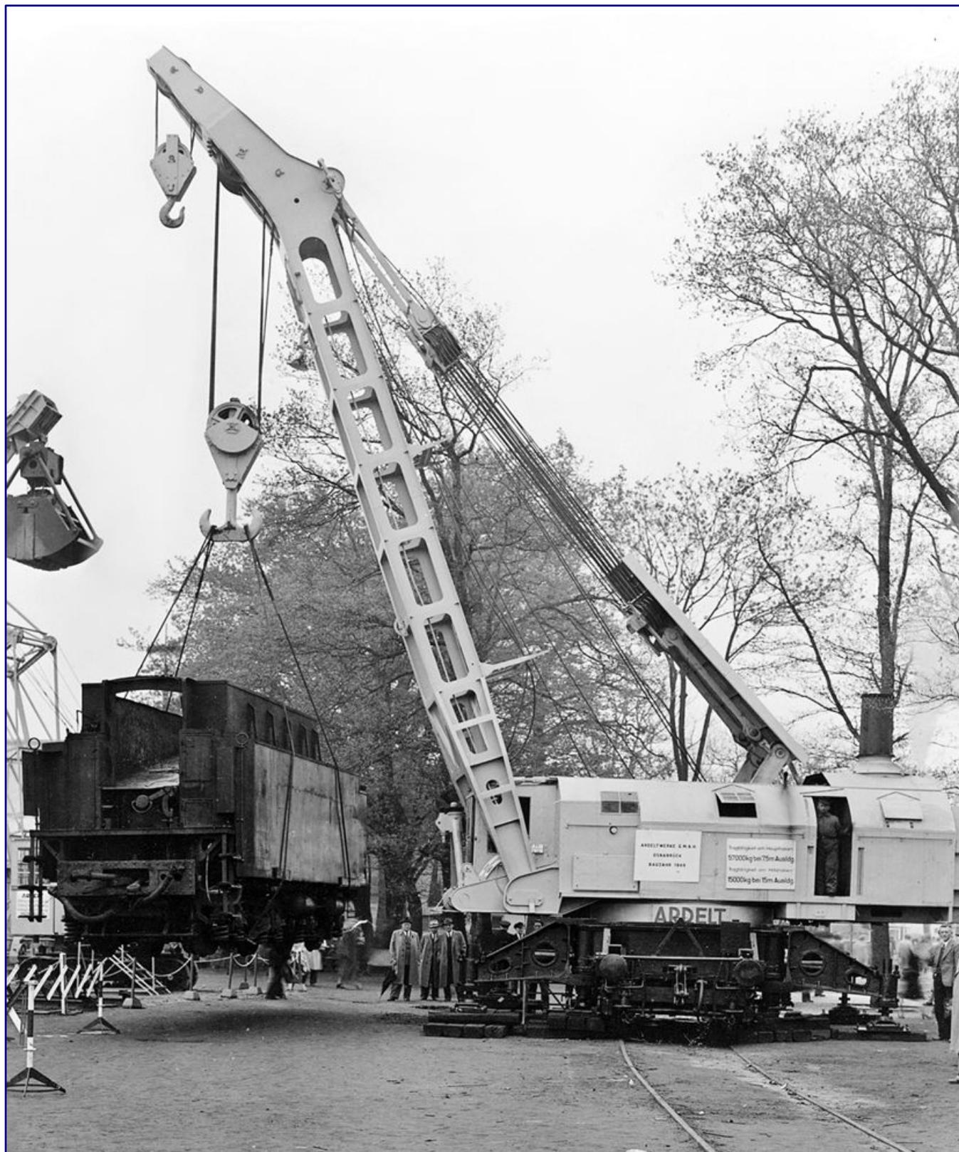
1957 gehörten die 57-Tonnen-Kräne von Ardelt noch zu den modernsten Hebewerkzeugen, die die Bundesbahn zu bieten hatte. So wird im Rahmen einer Messevorführung an einem Tender die Leistungsfähigkeit des offenbar goldgelb lackierten Schienenkrans vorgeführt. Dies geschieht bei geringer Ausladung, aber maximaler Abstützung. Interessant für die heute vorzustellende Modellumsetzung ist die Schichtung der Bauswellen, auf denen die Stempel der Stützen ruhen. Foto: Slg. Eisenbahnstiftung.
