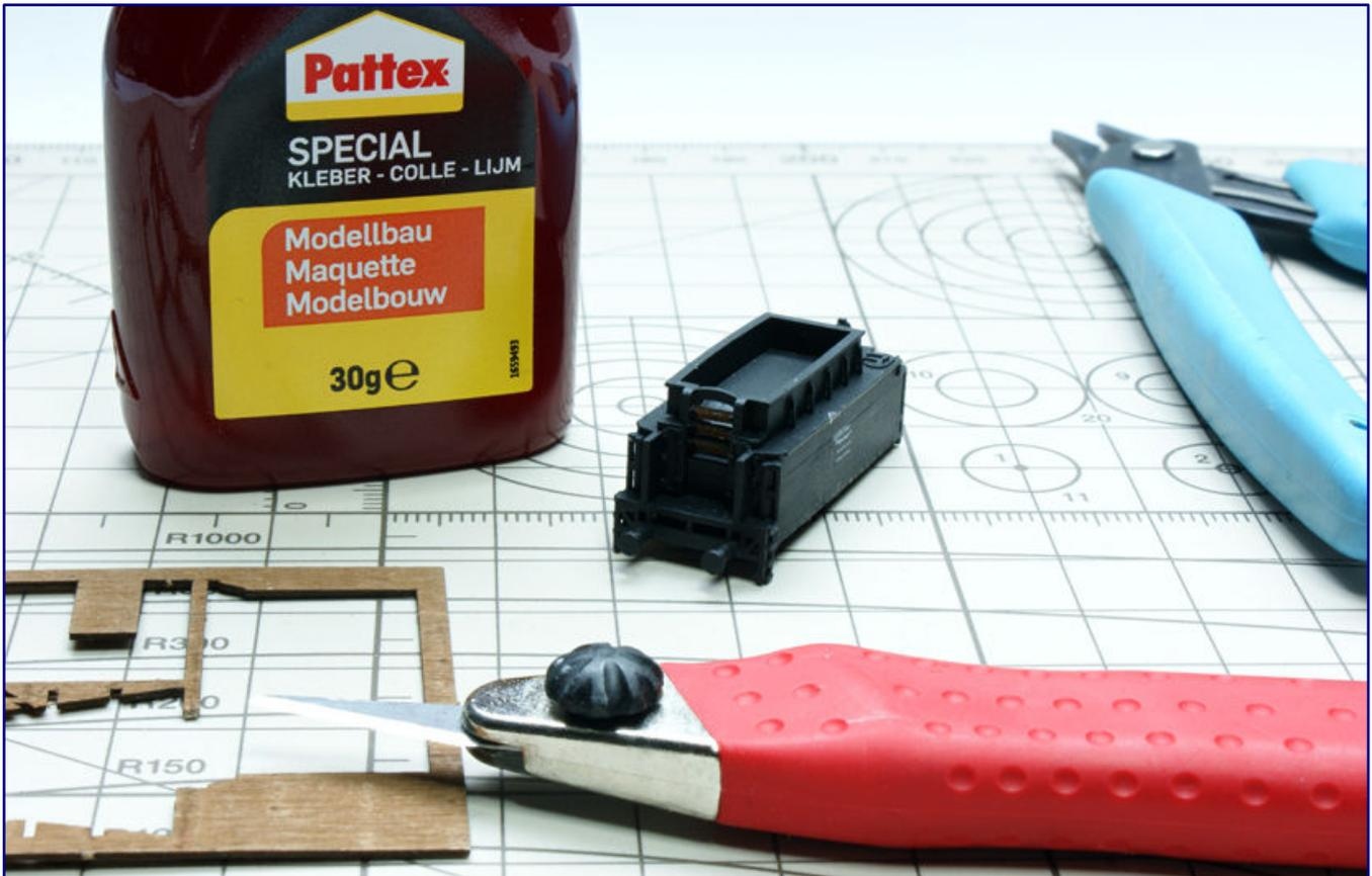
Die Steckbretter an der Kohlenentnahme entstehen aus dem Rest eines Holzbogens, der beim Bau eines Gebäudes übriggeblieben ist. Zum Verkleben des Materials mit Kunststoff / Kunstharz erweist sich Pattex Special als perfekt, der seit einiger Zeit im Henkel-Programm zu finden ist.
