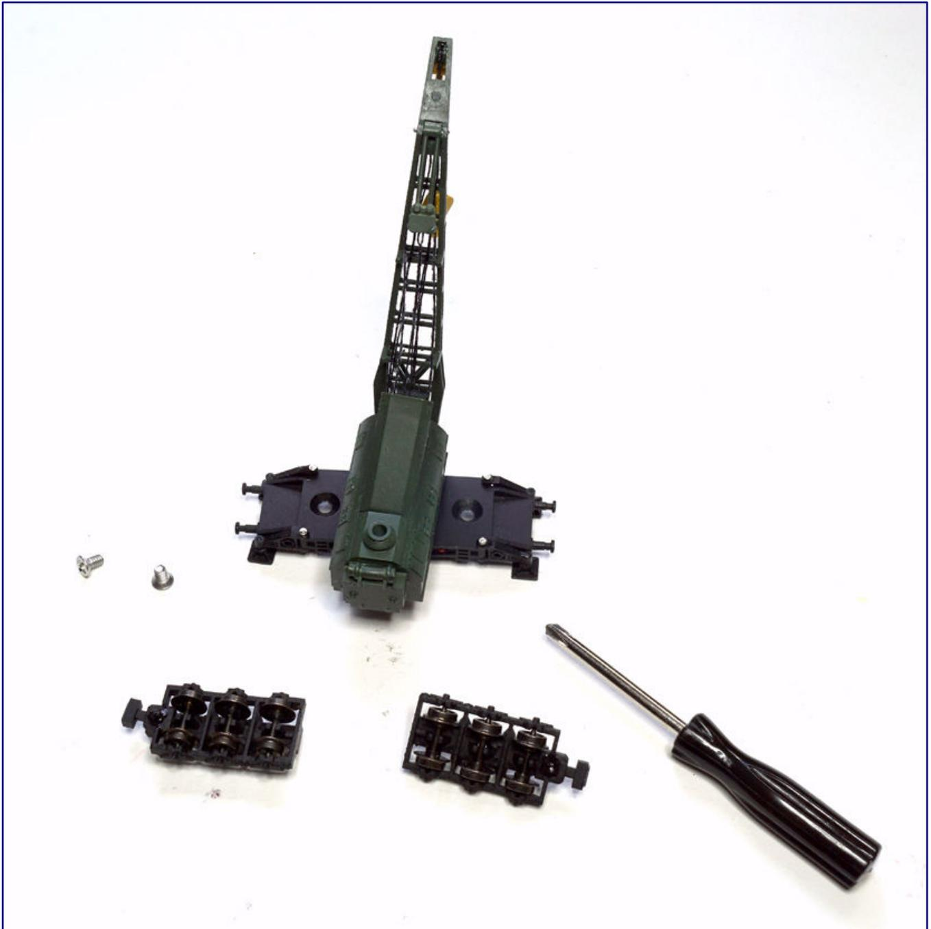
NoBa-Modelle rät, erst ein Drehgestell in den Unterwagen zu schrauben, anschließend dann den Oberwagen zu montieren und erst dann das zweite Drehgestell. Wird, wie hier dargestellt, erst der Oberwagen verschraubt, ist das ebenso möglich: Wird der Ausleger um 90° gedreht, gibt er den Zugriff für beide Drehgestellschrauben frei.
