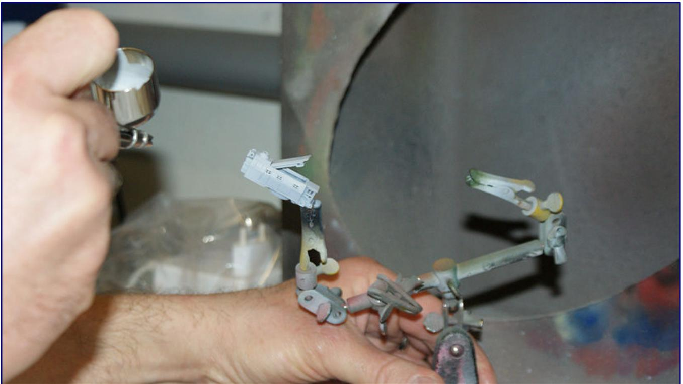
Erforderliche Verklebungen erfolgen bevorzugt mit dem LED-Light Booster von Uhu (Bild oben), weil er binnen fünf Sekunden nach Aktivierung per ultraviolettem Licht aushärtet und die beste Klebekraft aller bislang getesteten Klebstoffe erbringt. Vor dem Auftrag der Decklacke werden alle Resin-Teile grundiert (Bild unten). Bis auf die später schwarzen Teile ist ein hellgrauer Primer durchweg angezeigt.
