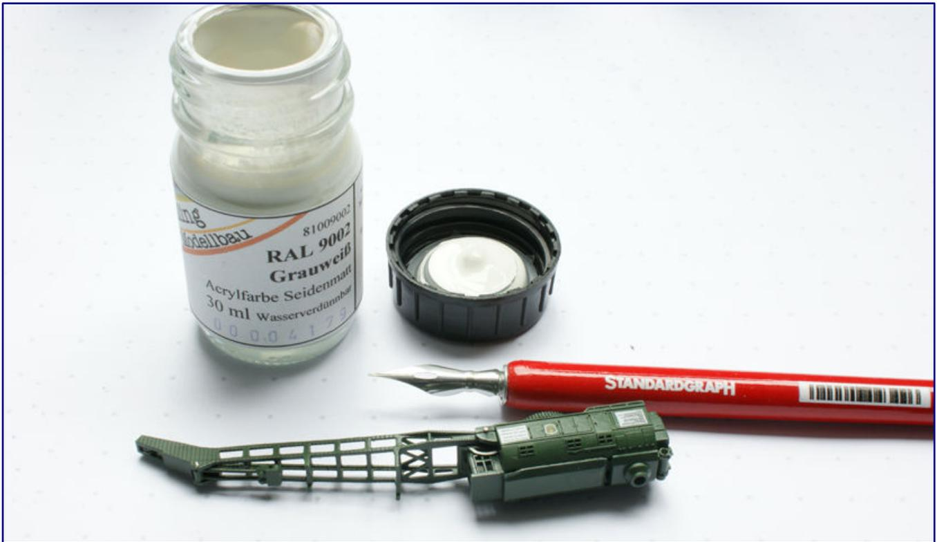
Wie hier beim Absetzen der Neigeskala am Führerhaus kommen auch beim Verglasen der Kabinenfenster Zeichenfeder und Federhalter von Standardgraph zum Einsatz. Sie erweisen sich als wertvolle Werkzeuge für jeden feinsten und präzisen Farbauftrag!
