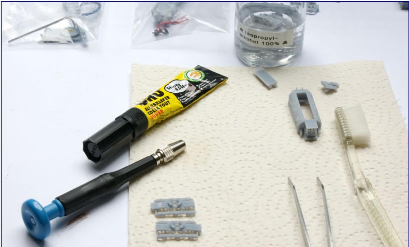
**Wichtig für den späteren Farbauftrag sind absolut fettfreie Teile. Deshalb unterziehen wir die Resindrucke noch einem eigenen Bad in Isopropylalkohol.**
