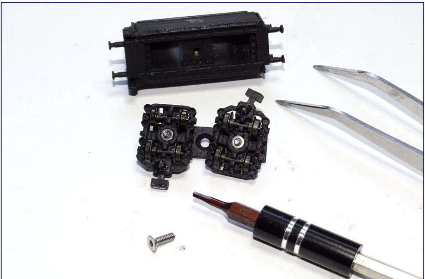
Die Schrauben der Drehgestelle greifen von oben durchs Fahrwerk in die eingeklebten Muttern. Der Fahrwerksboden wird hingegen von unten mit einer Innensechskant-Schraube in der eingeschmolzenen Hülse des Tendaraufbaus verschraubt.
