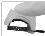
Figure 2 : Appuyer sur la section intermédiaire du dispositif de préhension jusqu'à ce que son introduction se fasse sentir.
