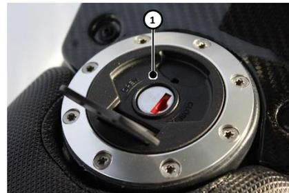
**Nota:** Verifique se a tampa do reservatório do combustível não contém sujeira ou água, de forma a deixar o respiro da tampa trabalhar propriamente, evitando problemas de injeção ou paragem do motor.
