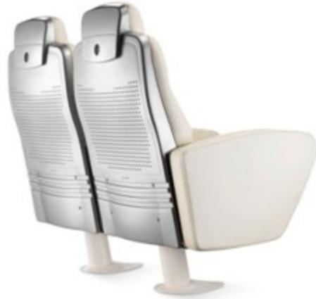
El asiento y respaldo están compuestos por dos bloques de espuma de poliuretano moldeada, que llevan una estructura interior metálica incorporada y la tapicería totalmente integrada a la espuma mediante el sistema Integral Form, sin costuras ni cosidos (a excepción, de las butacas tapizadas en piel). El sistema Integral Form garantiza una pieza exacta a la original en caso de reposición.
