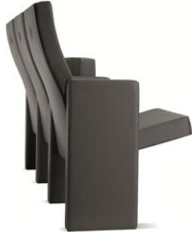
El conjunto de asiento, respaldo y paneles laterales están unidos por un puente central de acero. En este puente se encuentran los alojamientos de la rótula que reciben los ejes del asiento. Los laterales acaban en un zócalo inferior de acero, mediante el cual se fija la butaca al suelo, con tacos metálicos de expansión ocultos.
