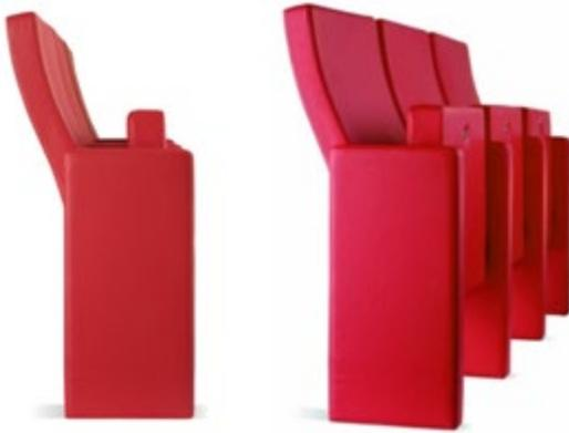
El asiento está formado por un monobloc compacto configurado por la espuma de poliuretano moldeada en frío que recubre completamente una estructura metálica, compuesta por un marco de tubo curvado, una trama de muelles planos y pivotes de articulación para el giro.
