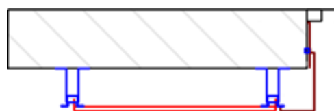
Remates perimetral de paramento
