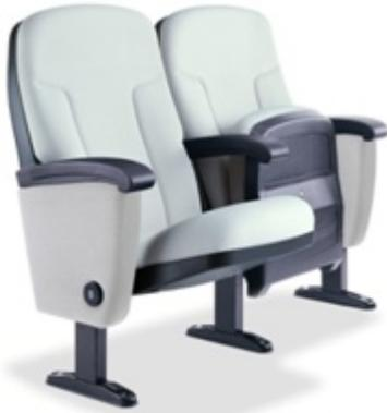
El asiento y respaldo están compuestos por dos bloques de espuma de poliuretano moldeada, que llevan una estructura interior metálica incorporado y la tapicería totalmente integrada a la espuma mediante el sistema Integral Form, sin costuras ni cosidos.
