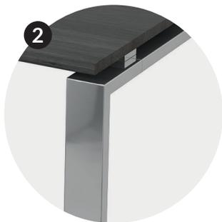
**2** Los laterales de la mesa están realizados en forma de portería con perfil de acero laminado en caliente de sección rectangular de 90 x 30 mm y un espesor de 2 mm. Acabado cromo. Dispone de un sistema doble de viga perfil de acero acabado de pintura epoxi anti-corrosión de alta resistencia, acabados en RAL9016 aluminio. Unidos mediante escuadras en forma de T en aluminio inyectado.
