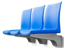
El asiento se fija a un perfil de acero de forma rectangular de 60x40mm, mediante una brida de fijación realizada en chapa de acero de 4mm de espesor que se une a una base inferior de chapa instalada en la parte inferior del asiento. El sistema permite reubicar e instalar cada localidad fácilmente.
