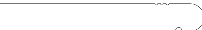
Rounded coping with drip and grooves Gradone arrotondato con gocciolatoio e scanalature
