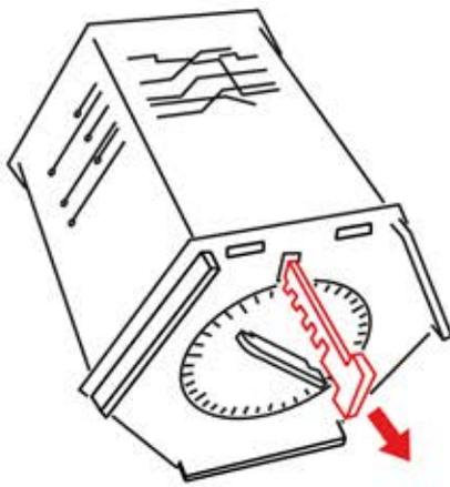
Den langen Stift an der unterseite der Box herausziehen.
