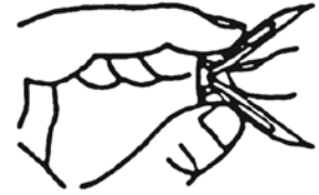
Fig. 14 - Cómo doblar el soporte de expansión
