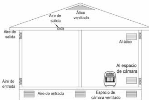
Fig. 2 - Ventilación aire desde el exterior
