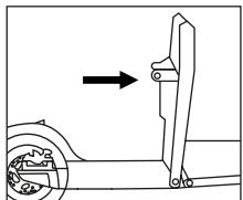
1. Pritisnite stražnji blatobran, povucite podlogu za stajanje prema gore i presavijte je prema stupu upravljača.
