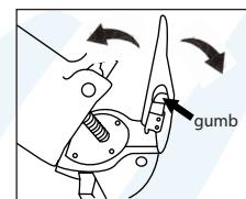
6. Gurnite gumb prema gore i odspojite stezaljke stupa upravljača, te preklopite stup prema donjem dijelu stupa.
