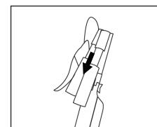
5. Povucite kopče za otpuštanje ručki upravljača, kako prikazuju strelice i ručke upravljača presavinite prema stupu.
