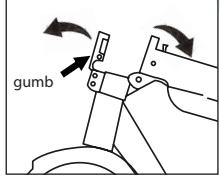
7. Gurnite gumb prema gore i otpustite kopču za preklapanje. Preklopite stup prema baznoj ploći.
