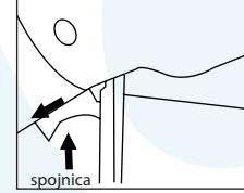
8. Potisnite zasun za preklapanje unazad i poravnajte ga s kukom na baznoj ploči. Nakon postavljanja otpustite stezaljku kako biste učvrstili stup.
