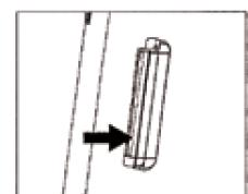
3. Nakon što ste gurnuli bateriju prema gore, izvucite je vodoravno paralelno sa stupom. paralelno sa stupom.
