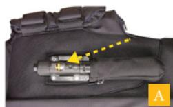
**A** Posición del mecanismo de activación tras ser activado. La hebilla y el cordón están fuera de lugar, el pistón se ha desplazado hacia el cartucho y el muelle (señalado con una flecha amarilla) está a la vista.
