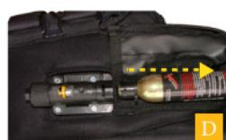
**D** Retire el cartucho de CO2 vacío del cuerpo del mecanismo de activación tirando hacia arriba.
