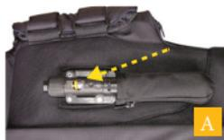
**A** So sieht der Auslöser nach Aktivierung aus. Der Sicherungsstift und die Reißleine wurden entfernt, der Kolben ist in Richtung der Kartusche gerutscht und die Feder (gelber Pfeil) ist sichtbar.
