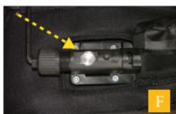
**F** Skjut genom utlösarens öppning, med fingret eller med hjälp av sexkantsnyckeln, kullen tillbaka till sitt utgångsläge. Kontrollera att silverkolvens försänkning är i linje med hålet i mitten på utlösningmekanismen – se bilden.
