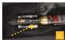
C När den kvarhållande flänsen på bajonettkopplingen når den högra sidan av fixeruttaget (visas med den gula pilen på bilden), kommer du att känna hur patronen lossnar i utlösningsmekanismen.
