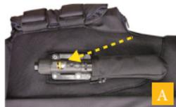
**A** Zo ziet het activeringsmechanisme eruit na activering. De veiligheidspen en de verbindingslijn zijn los, de zuiger is naar het patroon geschoven en de veer (aangeduid met een gele pijl) is zichtbaar.
