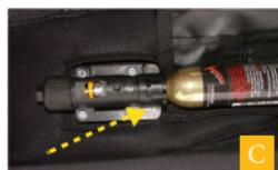
**C** Als de blokkeerlip op de bajonetsluiting de rechterkant van de gleuf (aangeduid met de gele pijl op de foto) bereikt, voelt u het patroon loskomen in het activeringsmechanisme.
