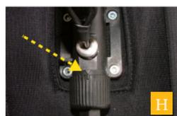
**H** Ziehen Sie die Abdeckung mit dem Innensechskantschlüssel, bis die Kappe mit dem Auslöser bündig abschließt und die Markierungen auf dem Auslöser mit denen auf der Abdeckung übereinstimmen (gelber Pfeil).
