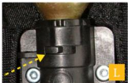
**L** En exerçant une légère pression vers le bas, tournez la cartouche de CO<sub>2</sub> dans le sens des aiguilles d'une montre vers la gauche, comme indiqué par la direction de la flèche jaune du haut sur l'illustration, jusqu'à ce que la languette de localisation sur la fermeture à baïonnette se trouve du côté gauche de la fente de localisation.
