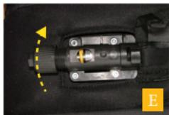
**E** Draai de dop met de veer los met de meegeleverde inbussleutel door in de richting van de pijl te draaien tot u de veer niet meer ziet onderaan de opening van de veiligheidspen in het activeringmechanisme.
