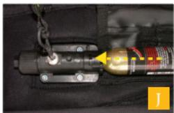
**J** Pour insérer une nouvelle cartouche de CO<sub>2</sub>, commencez par vous assurer qu'elle est dotée de la fermeture à baïonnette appropriée. Il est impossible d'utiliser des cartouches à vis dans le système de percuteur Point Two. Alignez la languette de localisation sur la fermeture à baïonnette (indiquée par la flèche du haut sur l'illustration) avec la fente sur le corps du percuteur (indiquée par la flèche du bas sur l'illustration).
