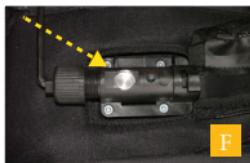
**F** Drücken Sie mit dem Finger oder dem Innensechskantschlüssel durch die Öffnung des Auslösers hindurch den Kolben zurück an seine Position. Stellen Sie sicher, dass die Vertiefung des silbernen Kurbels mit der Bohrung in der Mitte des Auslösergehäuses wie auf der Abbildung übereinstimmt.
