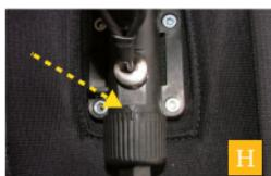
**H** Slutför åtdragningen av ändhylsan med hjälp av sexkantsnyckeln till dess att ändhylsans läpp är i jämnhöjd med utlösningmekanismen och markeringarna på utlösningmekanismen och ändhylsan står mitt för varandra som pilen visar.
