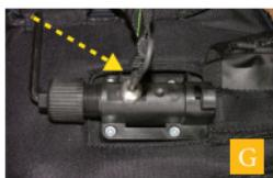
**G** Sätt utlösningssprinten i sin öppning, och se noga till att den är helt intryckt i kolvens försänkning. Håll utlösningssprinten på plats med en hand och börja dra åt fjäderns ändhylsa med den andra handen.
