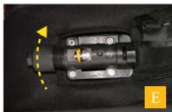
**E** Lösen Sie die Federspann-Abdeckung mit dem im Lieferumfang enthaltenen Innensechskantschlüssel. Drehen Sie diesen hierfür in die durch den Pfeil angegebene Richtung, bis die Feder unter der Öffnung des Sicherungsstifts des Auslösers verschwindet.
