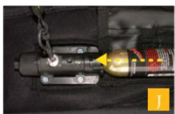
J Sätt kolsyrepasjonen i utlösningmekanismen. Om du känner motstånd, kontrollera att du korrekt ställt in positionsflänsen på bajonettfattningen mitt för isättningsskåran på utlösningmekanismen.
