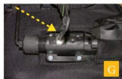
**G** Setzen Sie den Sicherungsstift in die Öffnung und stellen Sie sicher, dass er sich vollständig in der Vertiefung des Kurbels befindet. Halten Sie ihn mit der einen Hand und drehen Sie die Federspann-Abdeckung mit der anderen Hand wieder fest.
