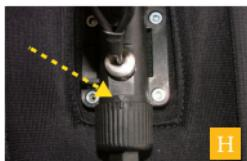
**H** Stringere il cappuccio usando la chiave a brugola, finché il bordo del cappuccio sia a pari con l'innesto e i contrassegni dei due componenti siano allineati, come indicato dalla freccia gialla.
