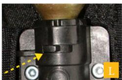
L Här visas i närbild positionsflänsens slutliga läge i utlösningmekanismens isättningsskåra.
