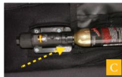
**C** Wenn das Verriegelungselement auf dem Bajonettverschluss die rechte Seite des Positionsschlitzes erreicht (gelber Pfeil im Bild), löst sich die Kartusche vom Auslöser.
