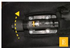
**E** Usando la chiave a brugola fornita, svitare il tappo della molla e ruotarlo nella posizione indicata dalla freccia, finché la molla rimane nascosta dietro l'innesto del meccanismo di attivazione.
