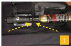
I När du ska sätta i en ny gaspatron, kontrollera först att den har den rätta bajonettfattningen. Man kan inte använda gaspatroner med skruvfattning i utlösningssystemet på ProAir2. Se till att positionsflänsen på bajonettfattningen (utmärkt av den övre pilen på bilden) hamnar mitt för isättningsskåran på utlösningmekanismen (utmärkt av den nedre pilen på bilden).
