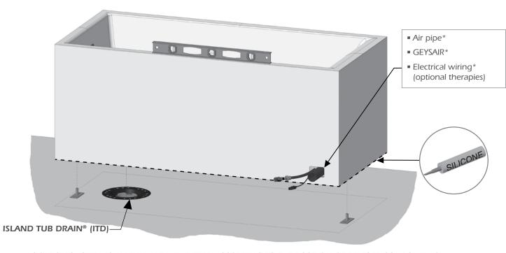
(\*): LOCATION SHOWN AS AN EXAMPLE MAY DIFFER ACCORDING TO THE POSITION OF REMOTE COMPONENTS AND LOCATION OF BATH. SEE PAGE 21 FOR INSTALLATION OF ISLAND TUB DRAIN®(ITD)
