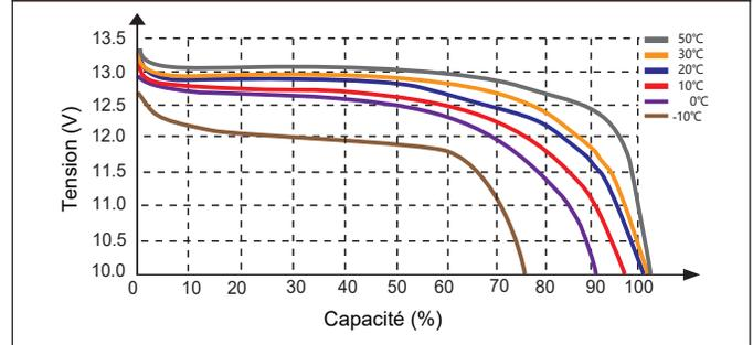
COURBE D'AUTODÉCHARGE À TEMPÉRATURE DIFFÉRENTE
