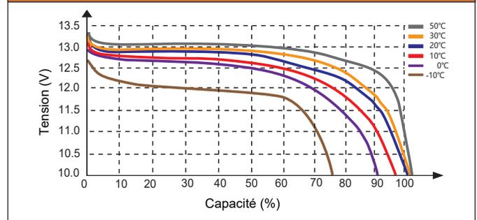
COURBE D'AUTODÉCHARGE À TEMPÉRATURE DIFFÉRENTE
