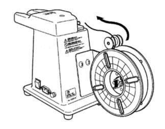
UNWIND THE RIBBON FROM THE SPOOL; BRING IT AROUND THE RIBBON SPOOL BRAKE ROLLER AND TOWARDS THE FRONT OF THE MACHINE. PLEASE NOTE THAT WHEN BRINGING THE RIBBON AROUND THE RIBBON SPOOL BRAKE ROLLER THAT IT IS IN DIRECT CONTACT WITH THE ROLLER AND UNDER THE METAL BAR THAT GOES ACROSS THE TOP OF THE ROLLER.
