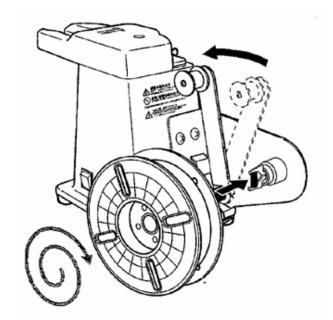
LOCATE AND FIND THE RIBBON SPOOL BRAKE ARM. PUSH THE RIBBON SPOOL BRAKE ARM TOWARDS THE FRONT OF THE MACHINE AND PUT THE SPOOL ONTO THE RIBBON SPOOL MANDREL SO THAT WHEN PULLED THE LEADING END OF THE RIBBON IS GOING TOWARDS THE RIBBON SPOOL BRAKE ROLLER. SEE DIAGRAM.
