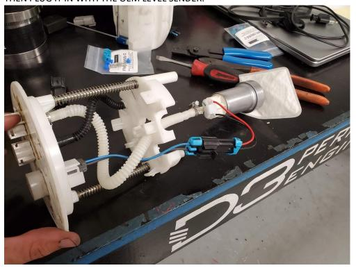
10. REATTACH THE BOTTOM OF THE FUEL PUMP BASKET TO THE UPPER SECTION, THE PUMP WILL JUST REST WITHIN THE BASKET
