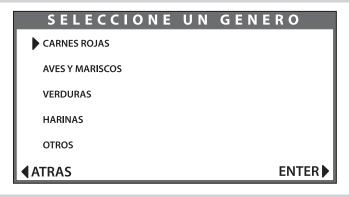
En la pantalla seleccione un espacio se muestran los campos donde se almacenan todas las recetas. Automáticamente aparecerá en pantalla los parámetros de la receta, los cuales podrá modificar respetando el límite de temperatura (250°C) y el límite de tiempo (09:00 Hrs.)
