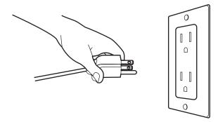
La toma de corriente es de 127 V con una frecuencia de 60 Hz tipo B (esta clavija cuenta con dos dientes paralelos planos y toma de tierra).
