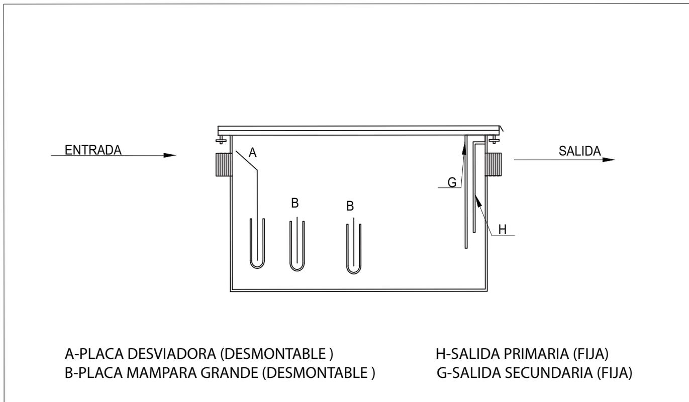
2-. Retire la placa de acero ,placa desviadora y las mámparas.
