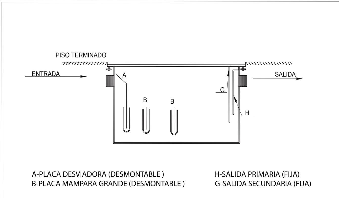
2-. Retire la placa antiderrapante ,placa desviadora y las mámparas.
