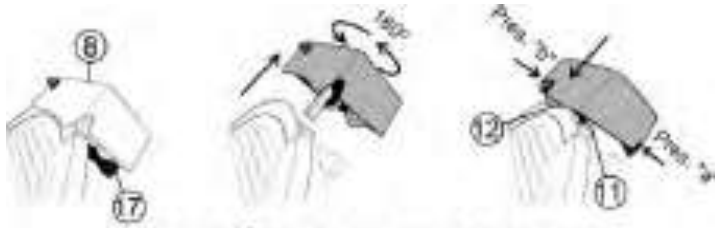
FIG 12. CÓMO AFILAR EL DISCO-CUCHILLA
