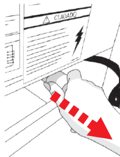
Tapón de drenaje*
