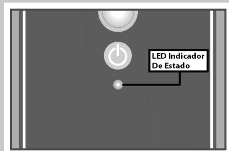
Para encender el horno debe presionar el botón de **ENCENDIDO/APAGADO**, al hacerlo en la pantalla nuevamente aparecerá el mensaje de bienvenida y el LED indicador cambiará de color rojo a color verde.
