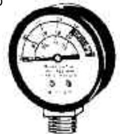
Fig. 4 Manómetro de vapor
