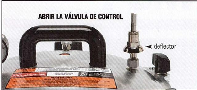
Hemos diseñado una nueva válvula de control que es mas grande y más fácil de operar. Ahora incorpora un deflector de protección que dirige y desvía cualquier vapor que se suelte hacia abajo. Al dirigir todo el vapor hacia abajo cada vez que se agota la unidad, el operador esta totalmente protegido de la nube de vapor de agua que se escapa.
