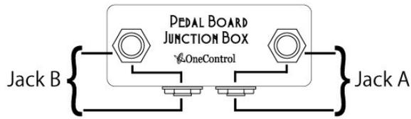
Jack A、Jack B それぞれ 2 つのインプットジャックが内部で接続されています。音声信号の方向はどちらでもお使いいただけますので、ご使用環境に合わせてご自由に接続してください。
