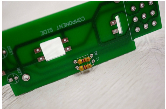
まず、2つの抵抗を PCB の 4.7K と書かれたところに入れます。向きはどちらでもかまいません。2つの抵抗はどちらも 4.7K のため、どちら側にとりつけてもかまいません。抵抗を写真のように PCB に挿し込み、裏側からはんだ付けし、余ったリード線をニッパーやペンチで切り取りま
