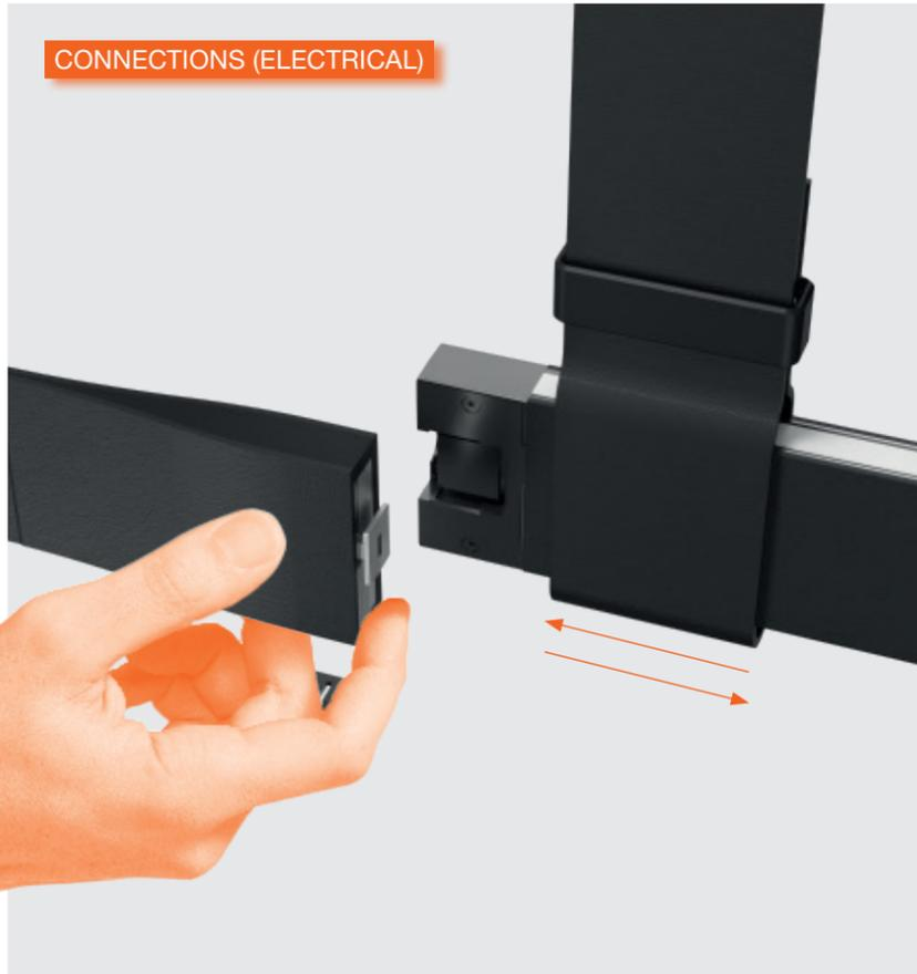
Lo speciale microconnettore integrato nel terminale del profilo luminoso permette di realizzare la connessione elettrica attraverso un semplice scatto. L'elemento di connessione viene nascosto all'interno del passante, che funge da sospensione per sostenere la composizione.
