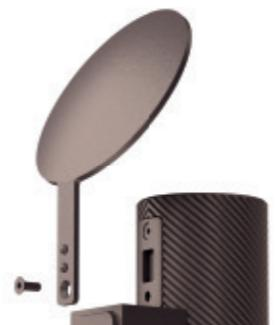
Accessorio deflettore, verniciato secondo la finitura del corpo lampada, installabile a discrezione sulla testa superiore o su quella inferiore e assicurato in posizione fissa da magnete e da vite di sicurezza, per creare un effetto decorativo di luce riflessa.
