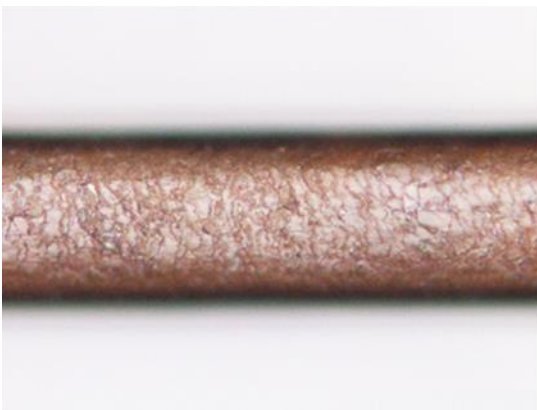
Cabello irradiado. Se observa una cutícula dañada, irregular y abierta.
