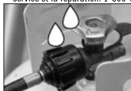
Détection des fuites Détendeur et tuyau
