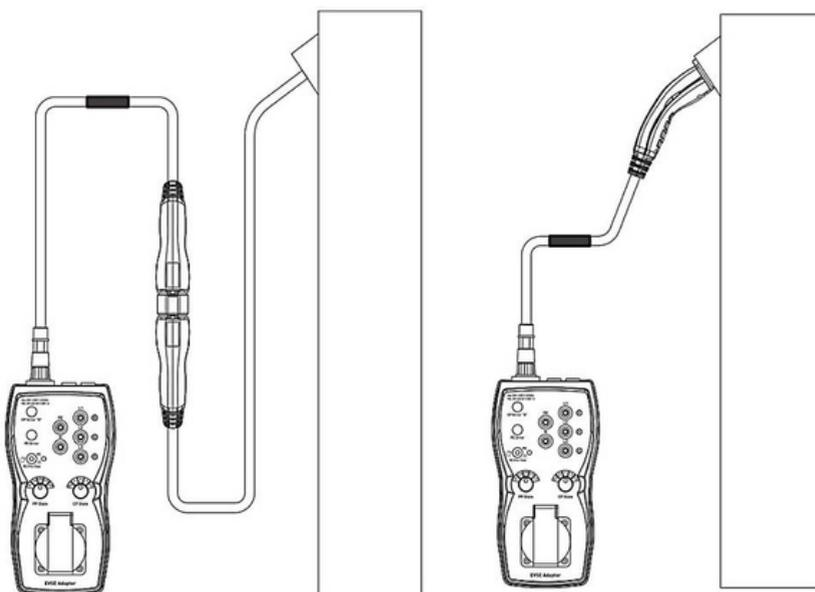
Connexion directe à la station de charge et connexion au moyen d'un adaptateur avec le câble installé en permanence.
