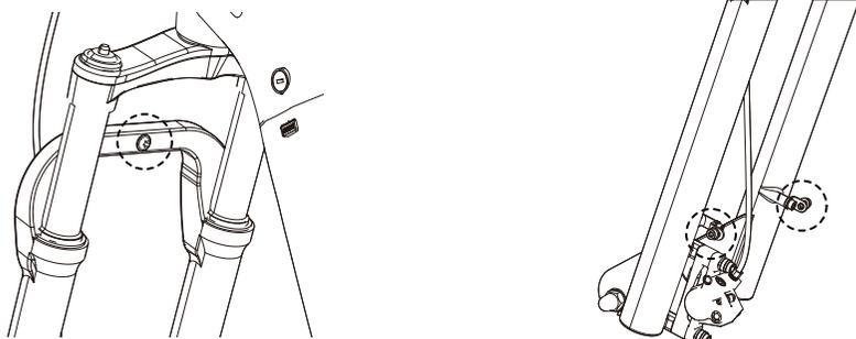
B. Alignez le garde-boue avant sur les trous de vis, utilisez une clé hexagonale de 4 mm pour serrer les vis de la fourche avant. (3 pièces)
