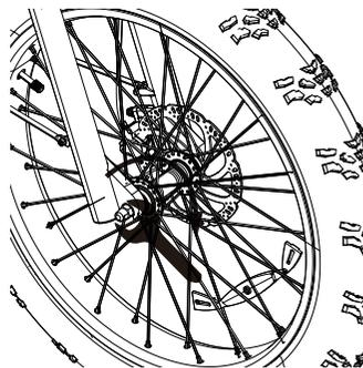
**Précautions:** Ne touchez jamais le disque de frein, surtout quand la roue et/ou le vélo est en mouvement, car cela pourrait entraîner des blessures graves. L'huile à main peut provoquer des grincements et réduire les performances des freins.
