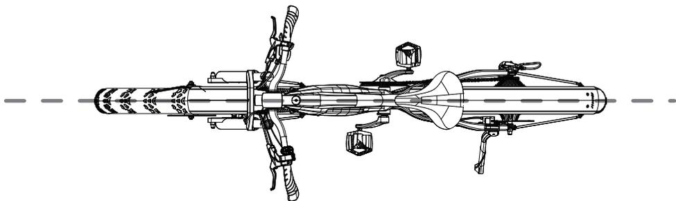
B. Asseyez-vous sur la selle, ajustez le guidon à la position souhaitée, serrez les vis qui se fixent au guidon avec une clé hexagonale de 4 mm
