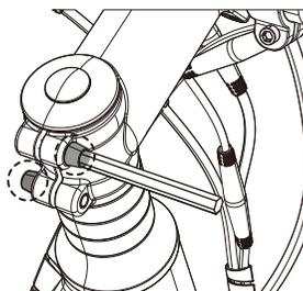
C. Ajustez l'écran à la position souhaitée, serrez les vis avec une clé hexagonale de 2 mm
