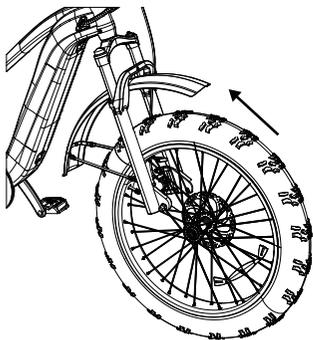
D. Utilisez une clef plate de 15 mm pour serrer l'écrou de l'essieu avant, la valeur de couple recommandée est à 25-30 Nm
