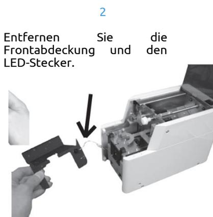
Entfernen Sie die Frontabdeckung und den LED-Stecker.
