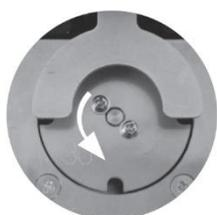
Die Drehung der Schraubenaufnahme in die entgegengesetzte Richtung ist ein Referenzpunktlauf des Schraubenaufnahmемotors.
