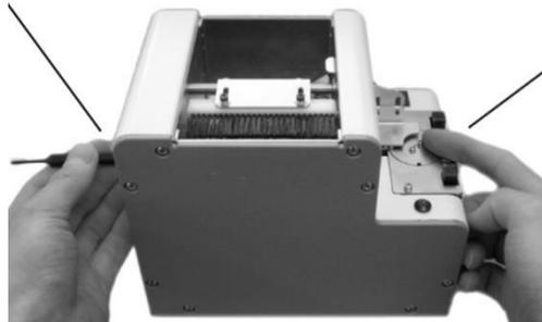
Wenn die optische Achse des Sensors abgefangen wird, reagiert der Timer und stoppt den Betrieb der Maschine.
