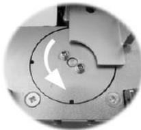
Die Drehung der Schraubenaufnahme in die entgegengesetzte Richtung tritt dann ein, wenn der Strom eingeschaltet wird und der Startpunkt der Schraubenaufnahme nicht mit dem Referenzpunkt des Schraubenaufnahmemotors ausgerichtet ist.
