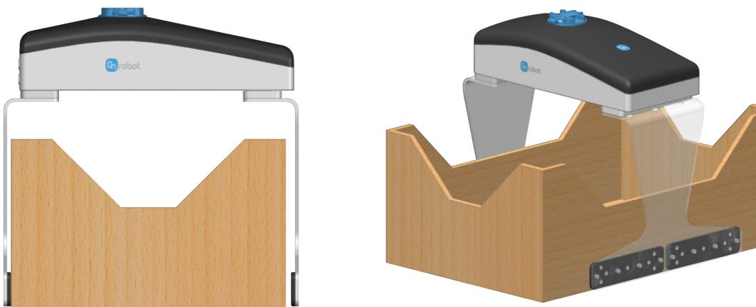
Durch die Vergrößerung der Fingerhöhe kann das zulässige Drehmoment verringert werden, wie im Abschnitt **Moments in the finger base** (Drehmomente in der Fingerbasis) angegeben.
