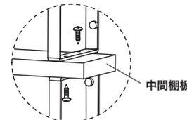
※中間棚板の厚さ18mm以下の場合、タッピンねじは干渉しないように、上下各1本で固定してください。
