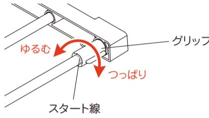
2 図で示す棚の2か所に長さ固定ねじを軽く回し仮付けしておきます。(この時、回しすぎると調整パイプが引き出せなかったり、傷が付きますので注意してください)
