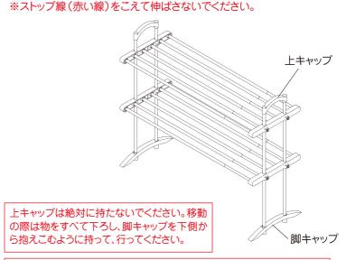
万一の事故を防ぐため、ステンレス棚の状態は定期的にチェックしてくだ さい。とくに固定ねじ(8箇所)に緩みがないか、また固定ねじの締め付け 部位に、ひび割れなどの破損がないか、よく点検を行ってください。
