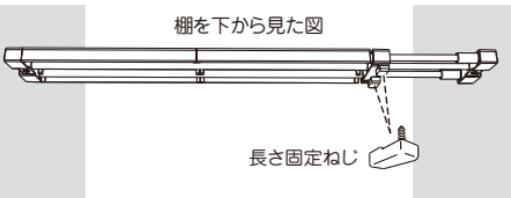
**5** 取付位置を調整し、壁が破損しないように確認をしながら、グリップを「つっぱり」の方向に回し、しっかり圧着固定させます。また、圧着力(取り付け力)を均等にするために2か所のグリップは均等に回してください。
