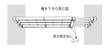
取り付け位置を調整し、壁が破損しないように確認をしながら、 グリップを「つっぱり」の方向に回し、しっかり圧着固定させます。 また、圧着力(取り付ける力)を均等にするために2か所の グリップは均等に回してください。
