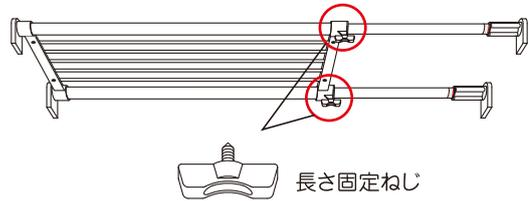
**5** グリップをシール表示の「つっぱり」の方向に回し、圧着固定します。棚は水平(壁に垂直)に取り付けてください。また、圧着力(取り付け力)を均等にするために2箇所(長さ固定ねじ)のグリップは均等に回してください。
