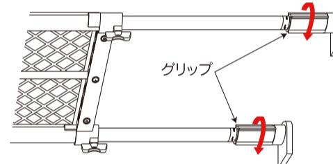
注意: 壁を破損しないように状態を確認しながらグリップを調節してください。
