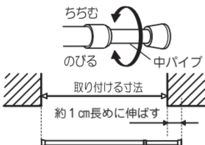
※伸ばす長さを調節することで圧着力は変わります。壁面の状態を確認しながら調整してください。
